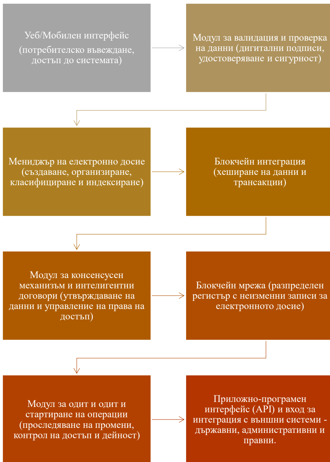
Фигура 2. Примерна интегрирана система за създаване на е-досие с блокчейн технология
